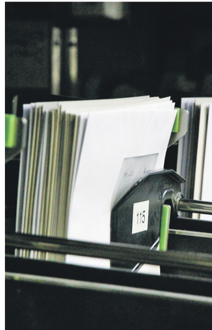
Automatisch sortiert die Maschine die Briefe dann nach ihrem Zielort und legt sie gruppiert in entsprechenden Fächern ab.
