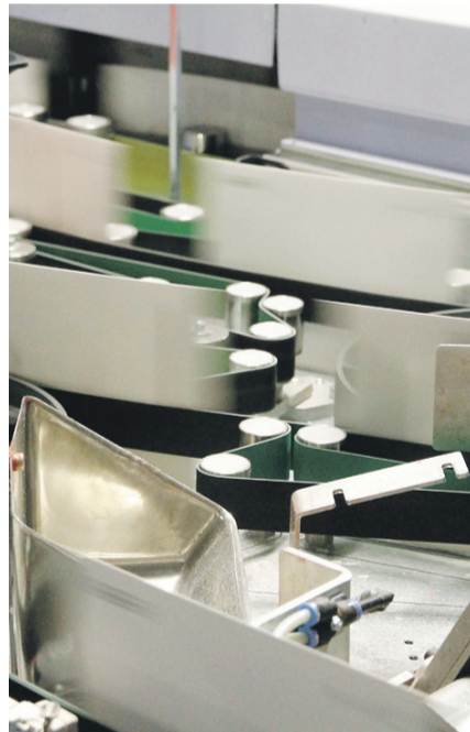
In horrendem Tempo flitzen die Umschläge an den Sensoren vorbei, die den Bestimmungsort jedes einzelnen Briefes ablesen.
