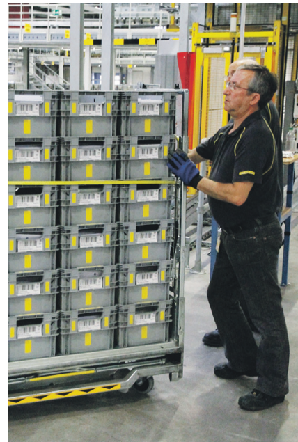
An Warenausgang nehmen Mitarbeiter die automatisch zusammengestellten Sammelbehälter wieder in Empfang und bringen sie zu der entsprechenden Lastwagenrampe.
