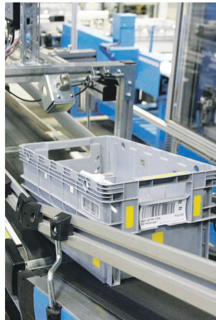
Sobald ein Kistchen wieder mit Briefen befüllt ist, erhält es einen neuen Strichcode. So wird es über die Förderanlage automatisch zur richtigen Ausgabestelle geleitet.
